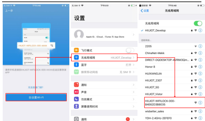
1-3: 根据提示长按门锁【设置按键】5S, 门锁提示“初始化成功”, APP内确认操作, 点击【下一步】。
