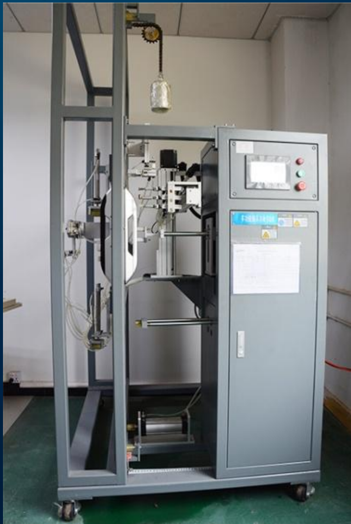
锁体及功能寿命检测实验设备
